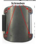
Der Empfänger ist in einem kleinen Gehäuse (Pager) untergebracht und wird am Oberarm mittels der im Gehäuseboden integrierten Armbinde getragen.
